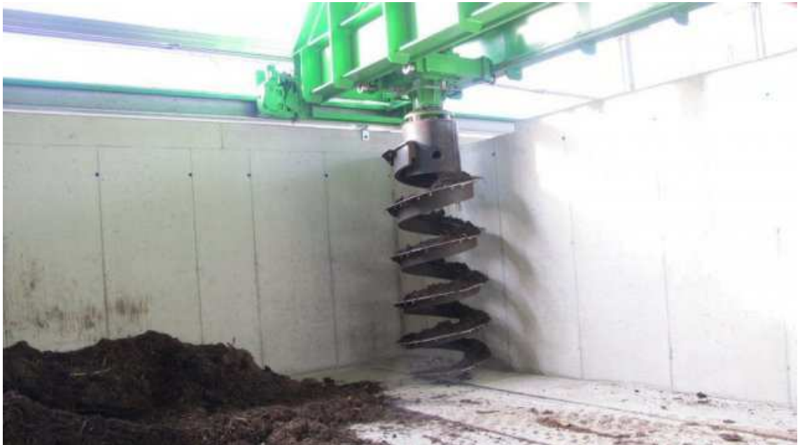
Figura 7: Sistema per il rivoltamento automatico dei cumuli, impianto di proprietà della Tricomix SA di Cadenazzo, progettato dalla azienda COMPAG AG. fonte: www.tricomix.ch
