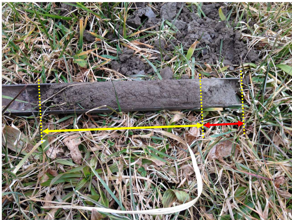
Figura 18: Carota di suolo prelevata nell'area di progetto. In giallo lo spessore di suolo (variabile da 20 a 40 cm massimo), poggiante direttamente su materiale alluvionale (indicato in rosso, costituito da sabbie fini ben selezionate). Non si osserva una separazione degli orizzonti A e B.
